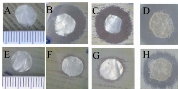
รูปที่ 3 ภาพถ่ายดิจิทัลจาก disc diffusion test โดยภาพแถวบนถ่ายจากจานเพาะเชื้อ S. aureus และภาพแถวล่างถ่ายจากจานเพาะเชื้อ P. aeruginosa (A)-(C) และ (E)-(G) แสดง zone of inhibition รอบแผ่นปิดแผลไฟโบรอินที่เคลือบด้วยสารละลายอนุภาคเงินนาโนความเข้มข้น 0, 1 และ 4 mM ตามลำดับ ส่วน (D) และ (H) แสดง zone of inhibition บนตัวอย่างแผ่นปิดแผลทางการค้า Aquacel Ag
